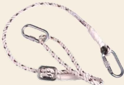
Cordino di posizionamento regolabile in poliammide diametro 12 mm completo di due moschettoni EN 362. Lunghezza massima 2 metri. Peso 550 grammi – Resistenza statica: > 15Kn
