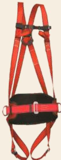
Imbracatura anticaduta in poliammide 45 mm con ancoraggio dorsale a "D" in acciaio e 2 attacchi sternali tessili, regolazione dello sterno e sui cosciali fibbie in acciaio zincato. Completa di cintura di posizionamento in poliammide 45 mm con schienalino termoformato 2 ancoraggi laterali a "D" in acciaio saldato e munita di 2 anelli di servizio con passante scorrevole per attacco borse portautensili. Peso 1500 grammi. Resistenza statica: > 15kN
