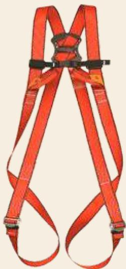
Imbracatura anticaduta in poliammide 45 mm con ancoraggio dorsale a "D" in acciaio saldato e 2 attacchi sternali tessili, regolazione dello sterno e sui cosciali fibbie in acciaio zincato. Peso 900 grammi. Resistenza statica: > 15kN
