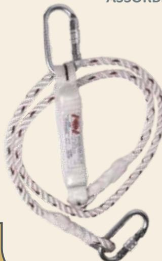
Assorbitore di energia composto da cordino di collegamento in corda poliammide diametro 2 mm, assorbitore in nastro poliammide da 32 mm e due connettori EN 362. Tirante d'aria 6 metri. - Peso 650 grammi – Resistenza statica: > 15Kn
